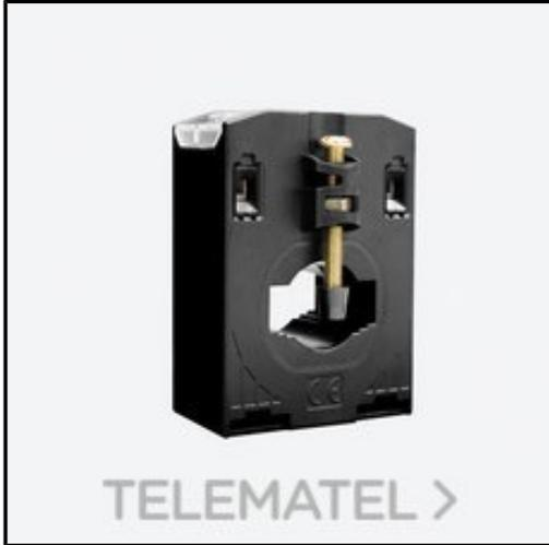
**CIRCUTOR - Transformador de corriente TD5.2 600/5A, pletina 25 x 12mm / 30 x 10mm / 20 x 20mm, sección útil 22mm, monofásico, clase 0,5 potencia 5VA, clase 1, potencia 7,5VA, clase 3, potencia 10VA, rango medida 600/5A, corriente de entrada 600A**
